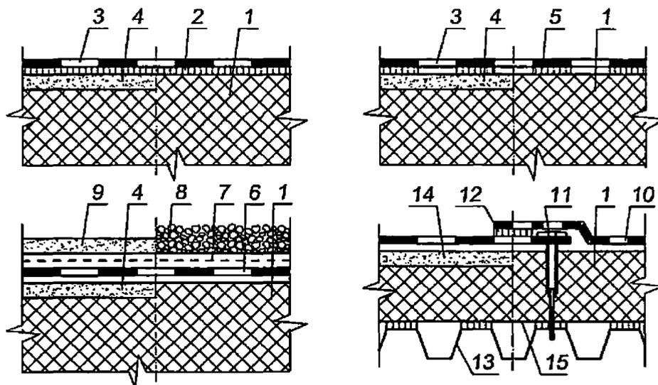
1 – теплоизоляция; 2 – сплошная приклейка; 3 – ковер; 4 – выравнивающая стяжка; 5 – частичная приклейка ковра; 6 – свободно уложенный ковер; 7 – предохранительный слой; 8 и 9 – пригруз из гравия или бетонных плиток (монолитный цементно-песчаный раствор, асфальтобетон); 10 – механически закрепленный ковер; 11 – крепежный элемент с шайбой; 12 – приклейка (сварка) продольных кромок рулонных материалов; 13 – профилированный настил; 14 – сборная стяжка; 15 – пароизоляция
