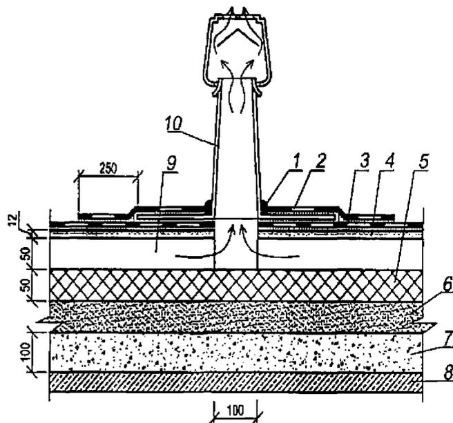
1 – герметик; 2 – дополнительный водоизоляционный ковер; 3 – основной водоизоляционный ковер; 4 – сборная стяжка из ЦСП или хризотилцементных плоских листов; 5 – минераловатные плиты; 6 – монолитная существующая стяжка; 7 – увлажненный пенобетон; 8 – железобетонная несущая плита; 9 – вентилируемый канал; 10 – аэратор диаметром 100 мм
