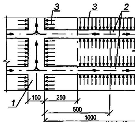
1 – вентиляруемый канал; 2 – диффузионные каналы; 3 – движение влаги
