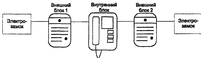
Рисунок 11 - Схема домофона из двух камер и одного монитора
